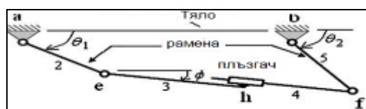
Фиг.5. Кинематична схема на звеното
