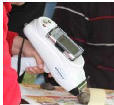
Фиг. 9. Преносимият спектрометър „Bruker S1 Sorter“
