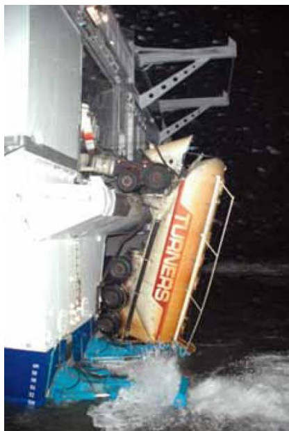
Фиг. 7. Цистерната изпаднала от кърмовата врата и държаща се на кабината [5]
