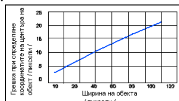
Фиг. 8. Грешка при определяне на координатите на центъра на обекта
