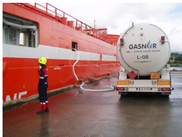
Фиг.12.Бункерование от камион на брега [13]
