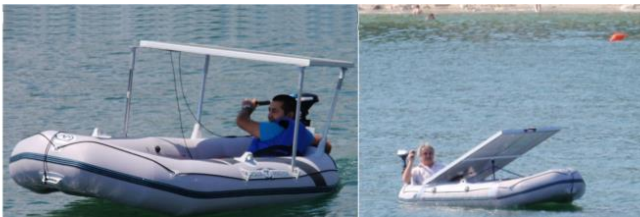
Фиг.12 Изпитания на надувна лодка с фотоволтаично задвижване
