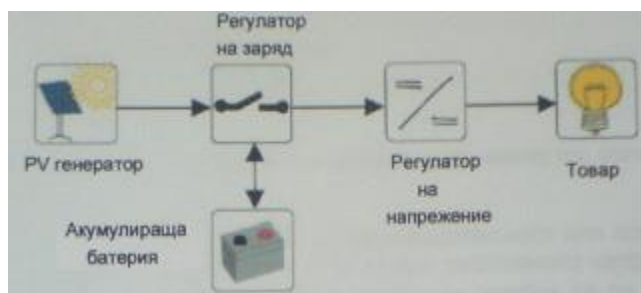
Фиг.3. Схема на фотоволтаична система
