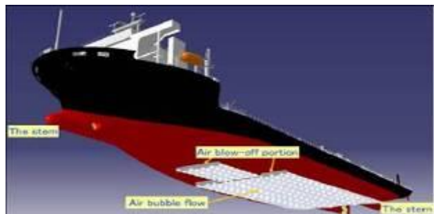
Фиг. 11. Система за въздушна смазка на Мицубиши (MALS)
