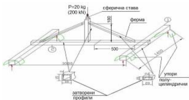
Фиг.4. Схема на фермената конструкция за монтиране на фотоволтаика
