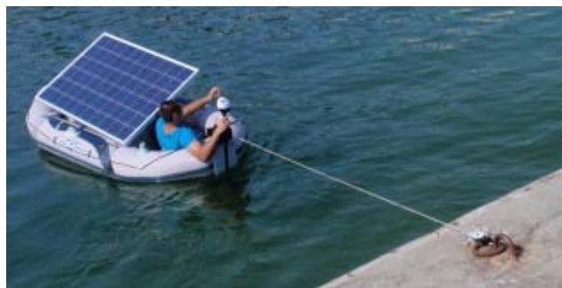
Фиг.10.Измерване упора на гребния винта във функция от ъгъла на падане на слънчевите лъчи спрямо плоскостта на фотоволтаика
