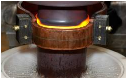
Фиг. 3. Процес на закаляване.
