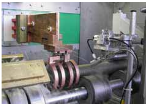
Фиг.4. Процес на отвърщане.
