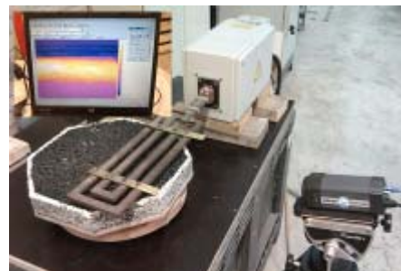
Фиг.10. Индукционно нагряване на асфалт
