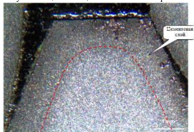
Фиг. 5. Макроструктура на цементования слой
