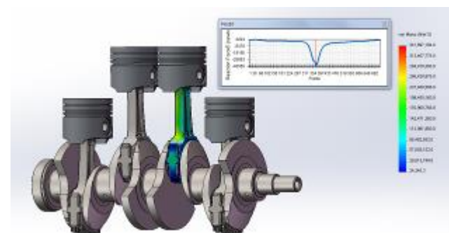
Фиг. 10. Еквивалентни напрежения, n=1500\text{min}^{-1} , 368°KB
