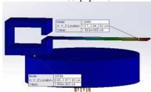
Фиг.2. Определяне преместването на пластинката и на вибромасата
