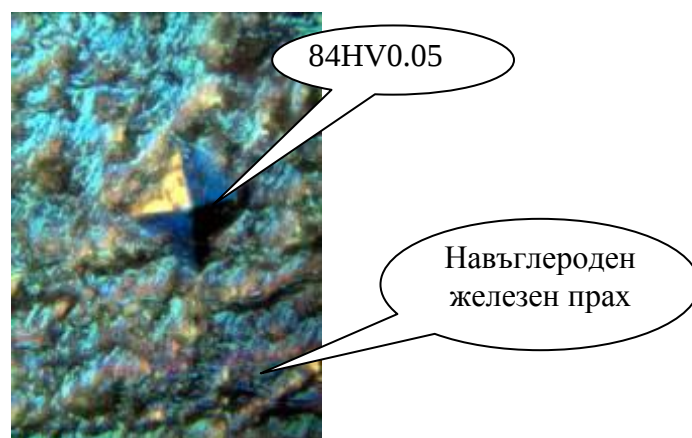
Фиг. 9 Микроструктура на проба с матрица Al и навъглероден железен прах и определена микротвърдост
