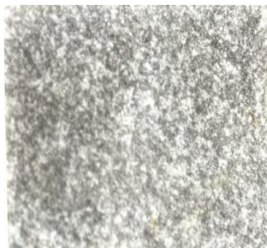
Фиг. 3. Микроструктура на образци от термообработена стомана X40Cr13 след разяждане на повърхността, x500
