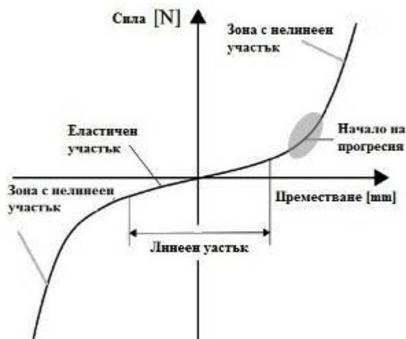
Фиг.2 Характеристика на виброизолатора.
