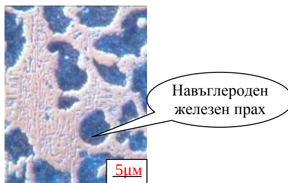
Фиг.5 микроструктура на проба с матрица мед уякчаваща фаза навъглероден железен прах- x400
