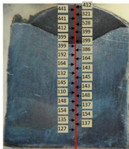
Фиг.7. Макрошлиф: зони на измерени твърдости HV0,05 след наваряване
