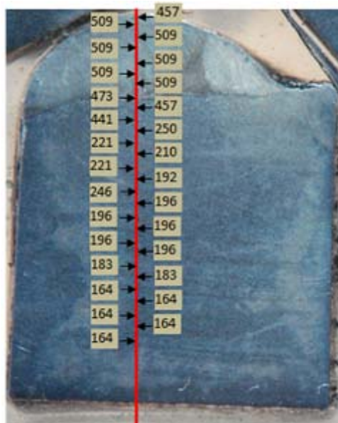
Фиг.7. Разпределение на микротвърдостите HV0,05 след наваряване с електрод ABRADUR54
