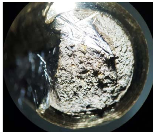
Фиг. 3. Макроструктура на ЛМК с матрица ЦАМ и уякчаваща фаза фибростъкло след изпитване на ударна жилавост.
