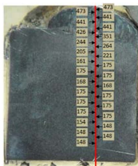
Фиг.7. Разпределение на микротвърдостите HV0,05 в изходния образец след наваряване с електрод ABRADUR58
