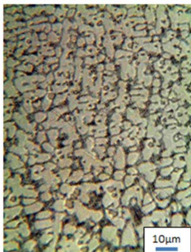
Фиг.5 Микрошлиф на граница на сплавяване, зона 2 x400
