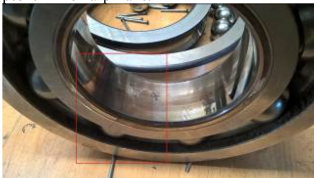
Фиг. 4 Локално разтопяване по вътрешния ринг на преден генераторен лагер и спукването му вследствие на мълния
