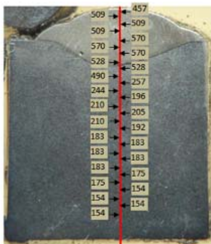
Фиг.9. Разпределение на микротвърдостите HV0,05 след наваряване с електрод ABRADUR64
