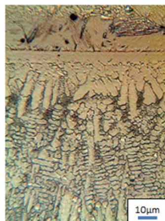
Фиг.6. Микрошлиф на граница на сплавяване x400
