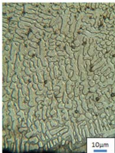
Фиг.4. Микрошлиф на наварен метал, зона 1 x400
