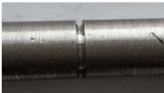
Фиг. 2. Образци за изпитване на ударна жилавост с V-образен надрез на MMCs с матрица ЦАМ и уякчаваща фаза стъклена влакна
