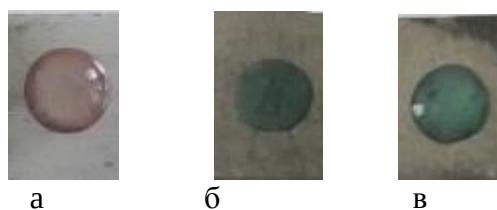
Фиг.9. Резултати от капкова проба на пробни тела от ECOsintHighCrA с наситен разтвор на CuSO 4 във вода: а/пробно тяло след спичане; б/пробно тяло след спичане и газово карбонитриране-30 мин. в/ пробно тяло след спичане и газово карбонитриране-60 мин.
