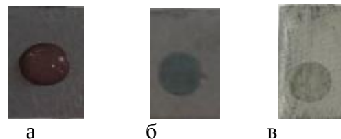
Фиг.8. Резултати от капкова проба на пробни тела от Ecosint C с наситен разтвор на CuSO 4 във вода: а/пробно тяло след спичане; б/пробно тяло след спичане и газово карбонитриране-30 мин. в/ пробно тяло след спичане и газово карбонитриране-60 мин.
