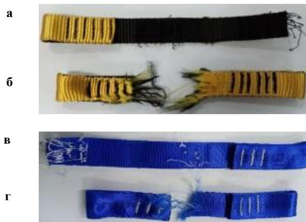
Фиг. 8. Примки след изпитването: а) от лентата с жълто-черна окраска разкъсана през шевове; б) от лентата с жълто-черна окраска разкъсана през лентата; в) от лентата със синя окраска разкъсана през шевове; г) от лентата със синя окраска разкъсана през лентата.
