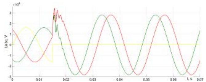
Фиг. 5. Изменение на фазните напрежения при изолиран звезден център
