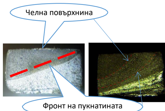
Фиг.5. лом разрушен от циклично натоварване;
