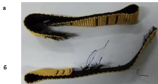
Фиг.9. Примки от лентата с жълто-черна окраска след изпитването: а) с тройно застъпване; б) с двойно застъпване.
