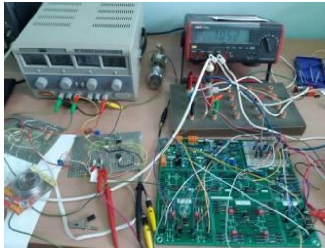
Фиг. 8. Схема на измервателната система, включваща тензодатчик с ОУ, захранващ генератор, мултиметр и режекторен филтър.
