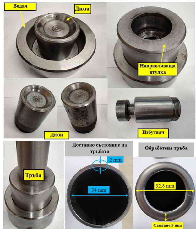
Фиг. 4. Инструментална екипировка за формоване чрез студена пластична деформация на тънкостенни тръби
