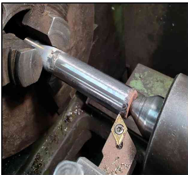
Фиг. 3. Механична обработка на наварения образец
