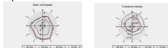
Фиг. 4.1.1. Скорост и турбулентност на вятъра по посока /60 m, 50 m, 40 m, 10 m/ за мачта 6052, m/s
