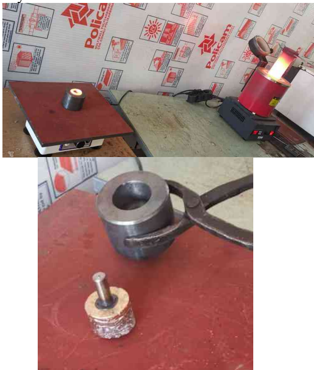
Фиг. 4. Заляти с алуминиев бронз образци от стомана 40X за получаване на биметали
