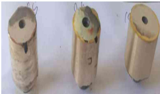
Фиг. 2. Наварени с алуминиев бронз биметални образци от стомана 40X
