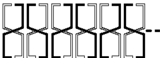
Фиг. 5. Структура от S-образни диполи
