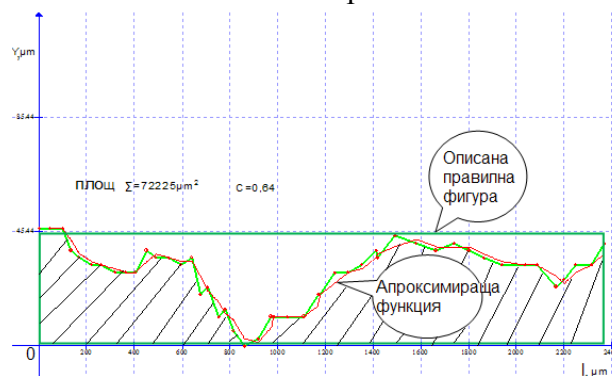
Фиг. 5 Изменение на грапавостта в горната част (горен ръб) на ряза; с-степен на грапавост
