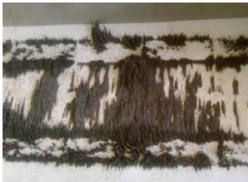
Фиг.5 Магнитосилови линии формиранни при посипване с феромагнитен прах.
