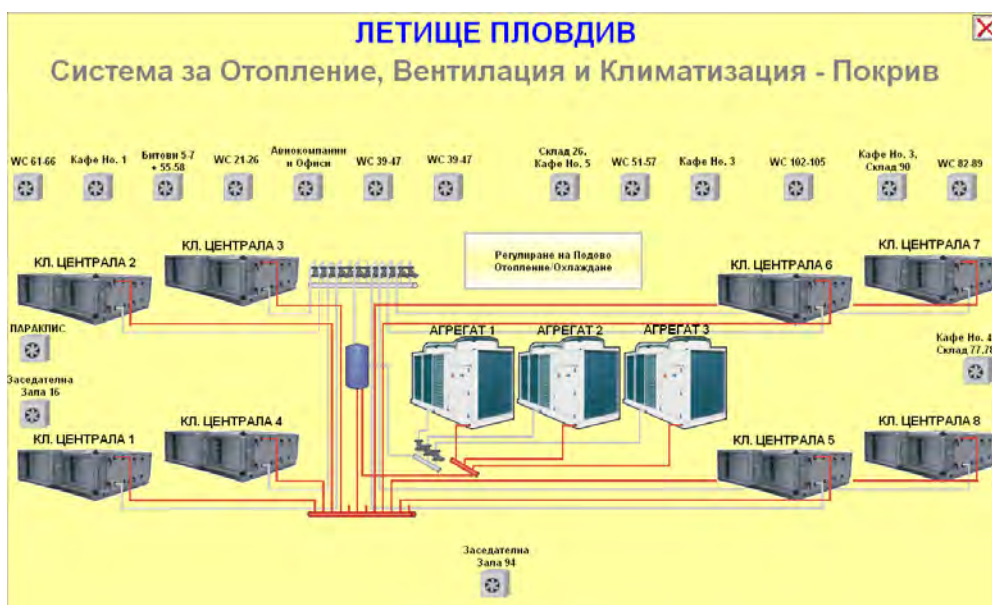
Фиг. 3 Щранк схема на подсистема „Климатични централи”
