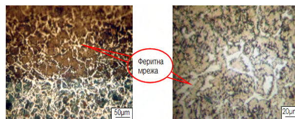
Фиг. 11 Микроструктура на границата между зоната на термично влияние и основния метал.
