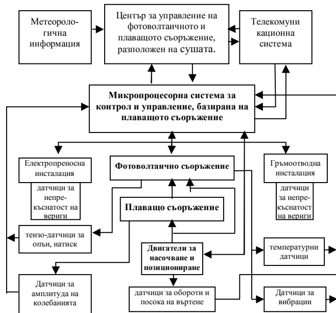
Фиг. 6. Блокова схема на базирана на вода мр-система за добив на слънчева електроенергия.
