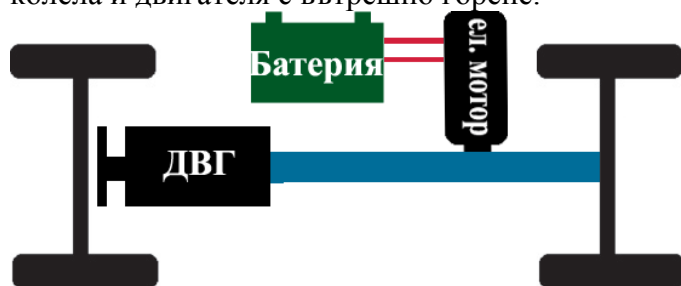
фиг. 2.3 Схема на паралелно задвижван автомобил
