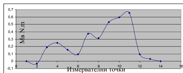
Фиг.8. Силово натоварване на свредлата при направа на отвор ф3,2 в Д16-Т
