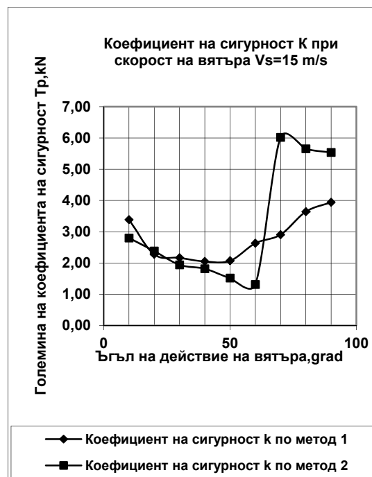
Фиг.8 Зависимост на коефициента на сигурност k от ъгъла на действие на вятъра при скорост v_s=15 m/s
