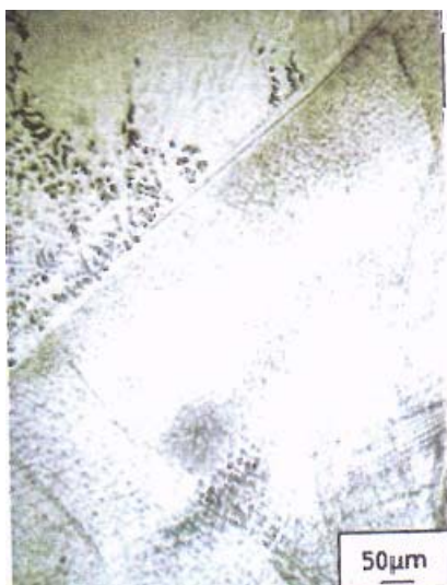
Фиг.11. Микроструктура на границата на сплавяване
