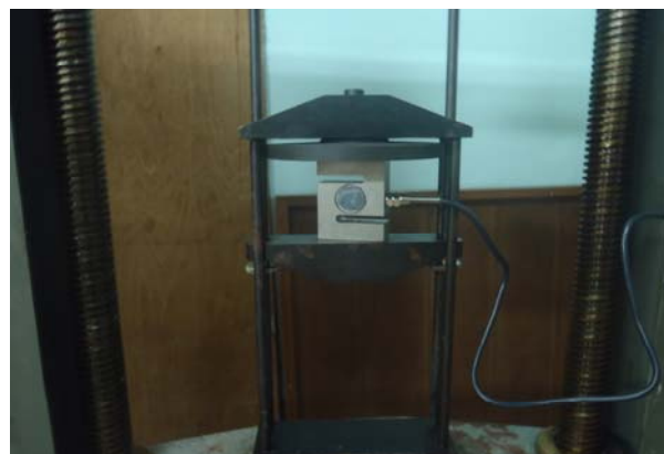
Фиг.7 Калибриране на силоизмерително устройство чрез еталонна тензоклетка при натиск
