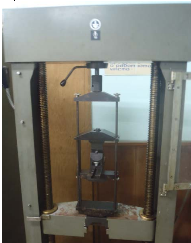
Фиг.3 Общ вид на работната част на универсална изпитателна машина FU1000, с монтирано приспособление за изпитване на огъване
