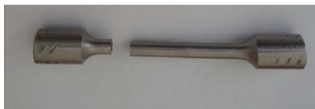
Фиг.13 Разрушен при изпитване на опън образец от ПМ стомана 316L с плътност 6.8\text{g/cm}^3
