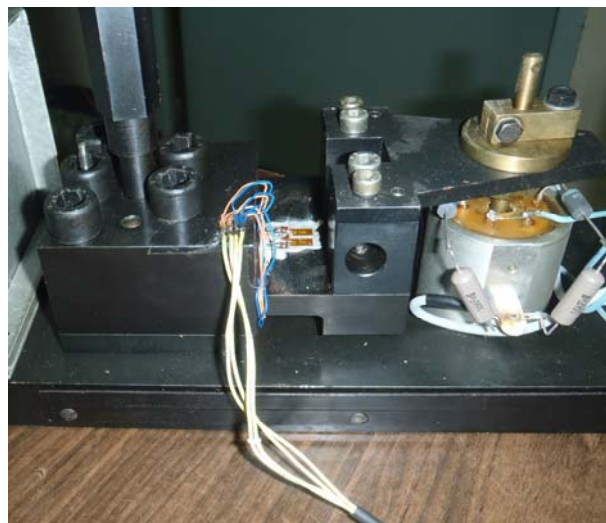
Фиг.5 Поставяне на тензодатчици на еластичният елемент на съществуващо силоизмерително устройство
