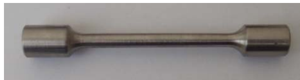
Фиг.8 Образец за изпитване на опън от синтерована стомана 316L
