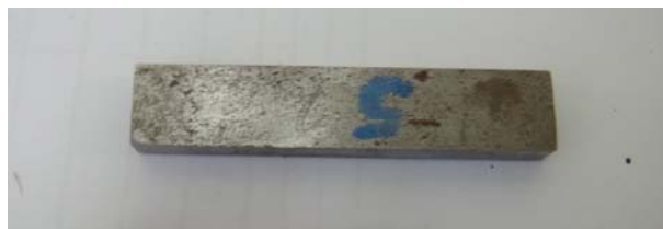
Фиг.9 Образец за изпитване на огъване от синтерована стомана Fe-3Cr-0.5Mo-0.4C с размери 50x10x5mm 3
