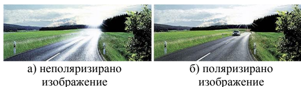
Фиг. 3 Сравнение на поляризирано и неполяризирано изображение
