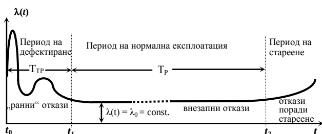
Фиг.1. Обобщен вид на интензивността на отказите – “Крива на ваната”.
