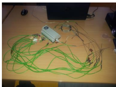
Фиг.2. Модул за измерване с Arduino, усилвател и мултиплексор.
