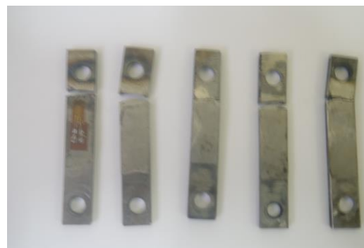
Фиг.3. Изпитани образци от стомана 40X със сечение 2.4 \times 10 \text{ mm}^2
