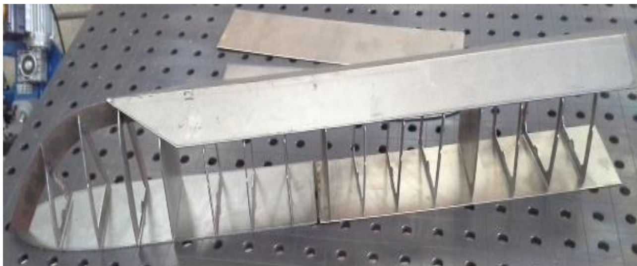
Фиг.1 Външен вид на единичен корпус от модел на катамаран с дължина 1000мм в етап на сборка.
