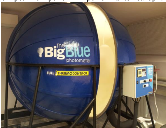
Фиг. 3 Интегрален фотометър със система за термоконтрол.
