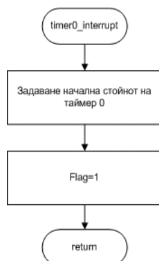
Фиг. 6. Алгоритъм на функцията за обработка на прекъсванията от таймер 0
