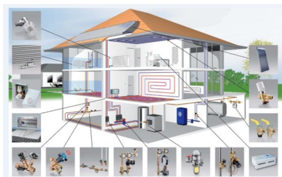
Фиг. 1. Отоплителна инсталация и анализираните елементи
