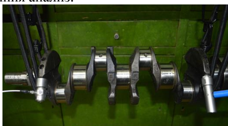
Фиг. 3 Изследване чрез модален анализ
