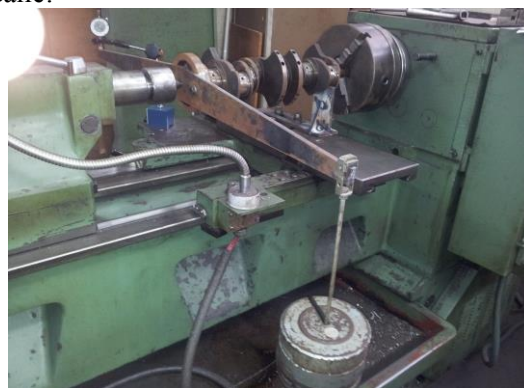
Фиг. 2 Изследване чрез чисто усукване
