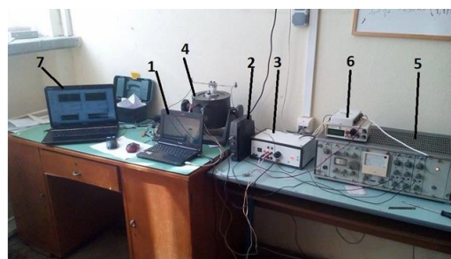
Фиг. 1. Реална установка за изпитване на вибрационна умора
