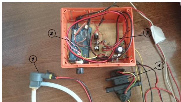
Фиг. 1 Схема на електронно управление на горивоподаването.
