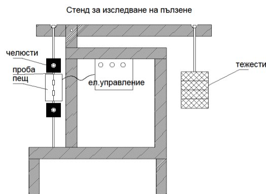
Фиг. 1. Стенд за изпитване на умора и пълзене.
