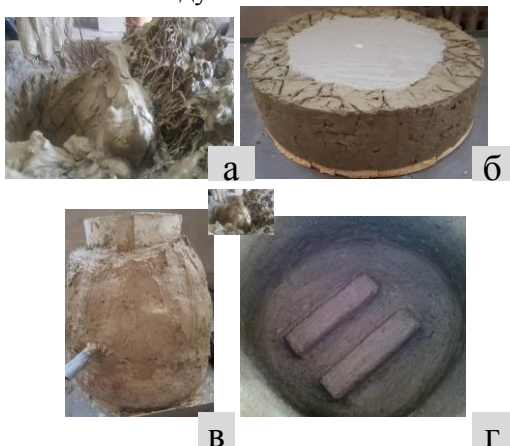
Фиг.1. Етапи на изработка: а/подготовка на материала, б/ изработване на основата и запълването и с пясък, в/ оформяне на пеца, г/ оформяне на дъното
