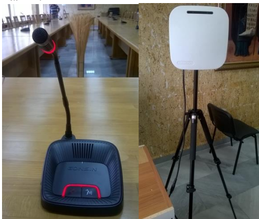
Фиг. 1. Председателски дискуссионен пулт DCS-3121C-W (вляво) и Безжичен Access Point WAP-30 (вдясно) в конферентната зала на ТУ-Варна
