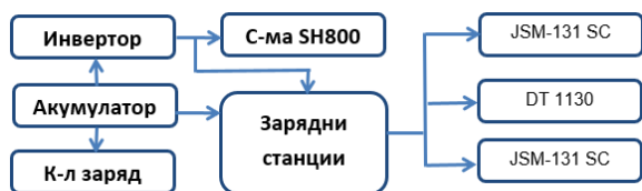
Фиг. 1. Блок схема на измервателната система.
