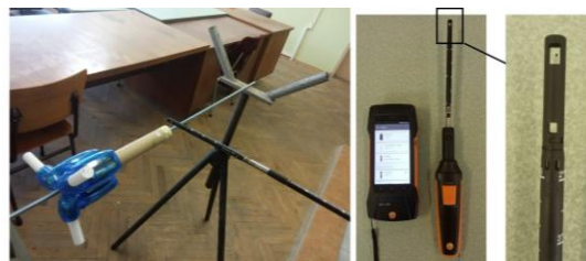
Фиг. 2. Позициониране на термоанемометъра след въртящите се цилиндри и измервателна апаратура
