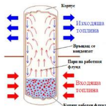
Фиг. 1 Схема на топлообмена в топлинна тръба
