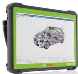
Фиг. 3. Диагностичен таблет Bosch DCU 120
