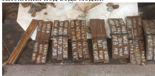
Фиг. 2. Образци за тестване на тръбния детайл
