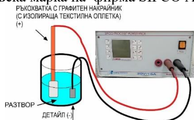
Фиг. 2. Схема за нанасяне на покрития
