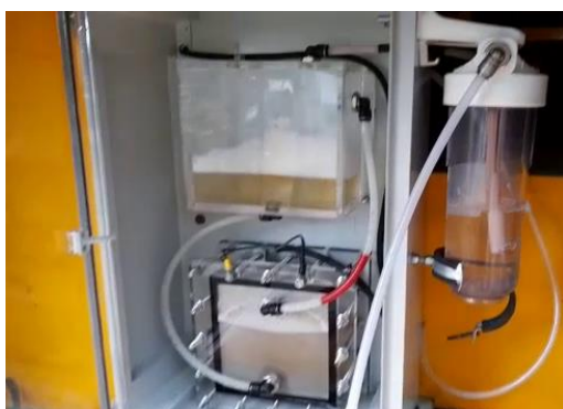
Фиг. 1. Общ вид на разработения генератор за оксигенород.
