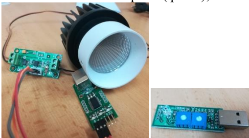
фиг. 1 LiFi прототипи- предавател (вляво) и приемник(вдясно)
