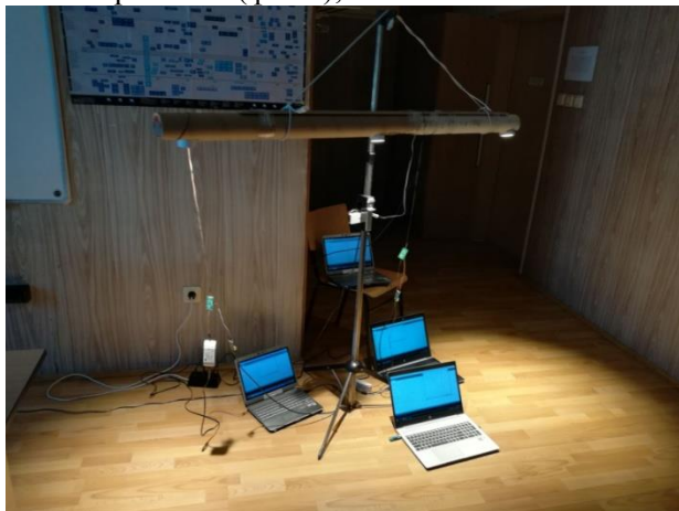
фиг. 5 Експериментална постановка за LiFi прототипи за хоризонтален хендовер
