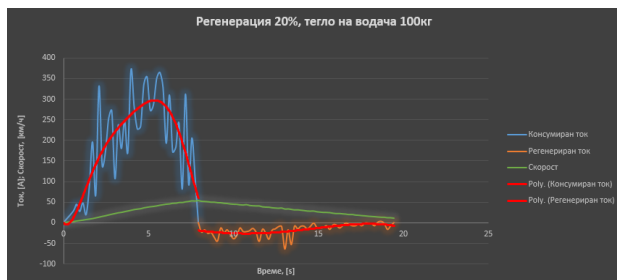
Фиг.2 Електромеханични характеристики на електрически мотоциклет (ускоряване до 50км/ч с последващо рекуперативно спиране)
