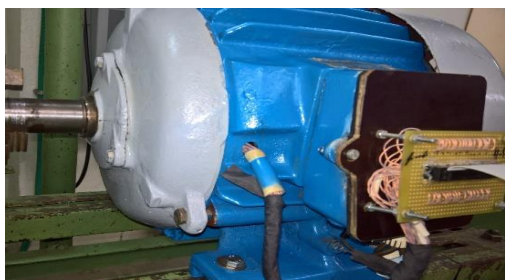
Фиг.1 Двигател с изведени термосензори
