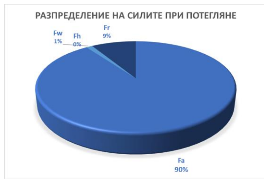
Фиг.1 Разпределение на силите при ускорение до 50 км/ч
