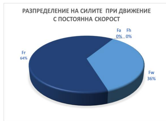
Фиг.2 Разпределение на силите при движение с постоянна скорост от 50 км/ч
