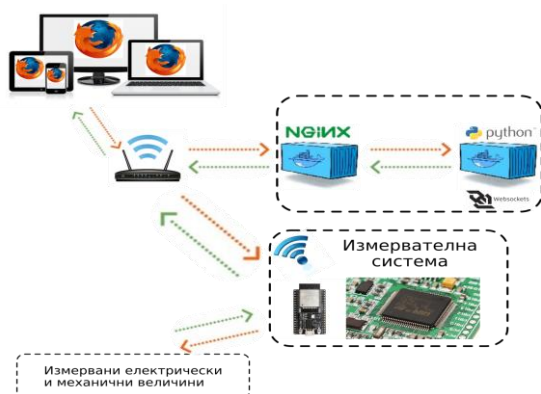
Фиг. 3. Система за синхронно измерване, обработка и визуализация на моментните стойности на електрически и механични величини.
