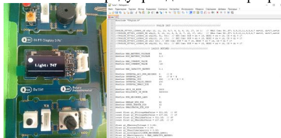
Фиг. 3. Мини дисплей с комплект датчици и листинг на програмата
