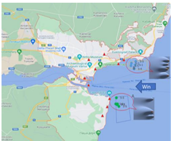
Фиг. 2. Карта на източниците на замърсяване (кораби в двете стоянки) и рецепторите на брега (червените триъгълници)
