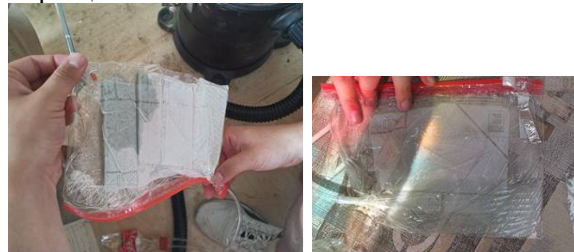
Фиг.2 Опитни образци в момента на вакуумиране
