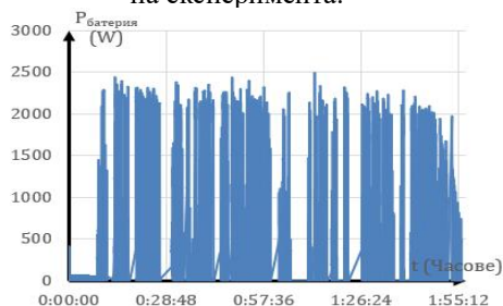
Фиг. 4. Консумирана мощност от електродвигателя по време на експеримента.
