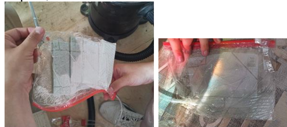
Фиг.2 Опитни образци в момента на вакуумиране
