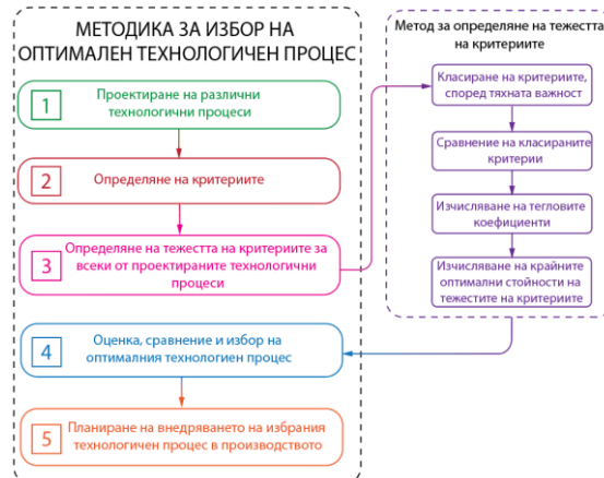
Фиг.1. Методика за избор на оптимален технологичен процес
