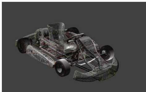
Фиг. 1. Конструирание на картинг автомобиля в средата на SolidWorks
