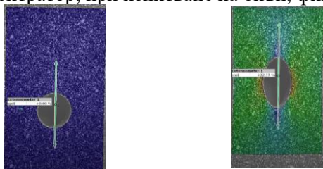
Фиг.2 Изследване на образец от полимерно фолио с концентратор, централен отвор
