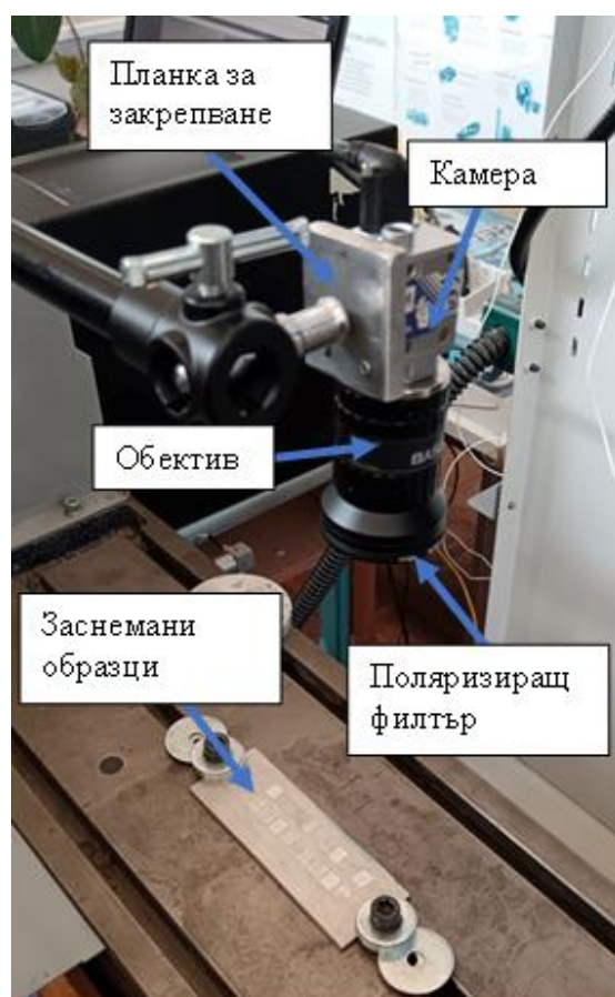
Фиг. 1. Закрепената камера по време на заснемане на изображения за попълване на базата от данни.
