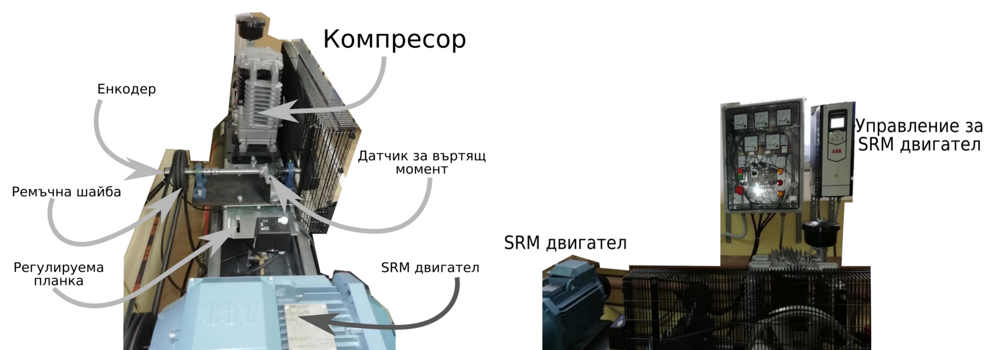
Общ вид на реализирания стенд с присъединен синхронен реактивен двигател
