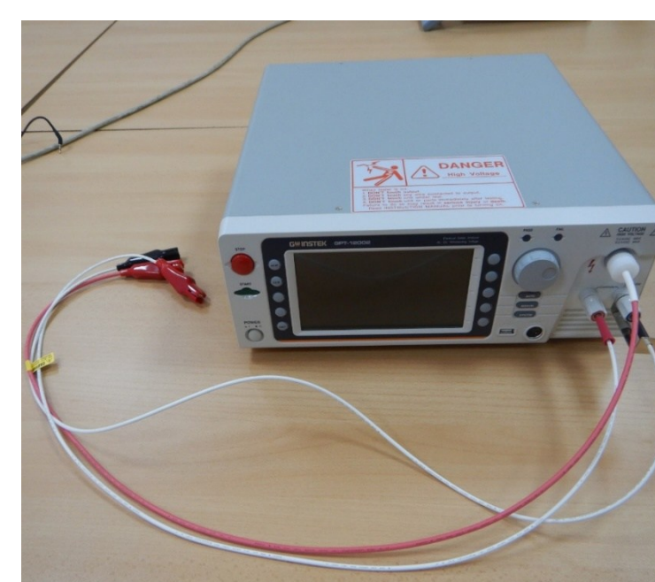
Фигура 3: Специализиран тестер за изследване на изолацията на електронни у-ва .
