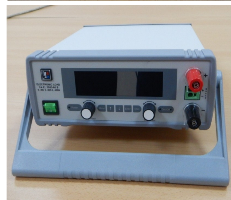
Фигура 4: специализиран електронен товар за изследване и тестване на електронни у-ва
