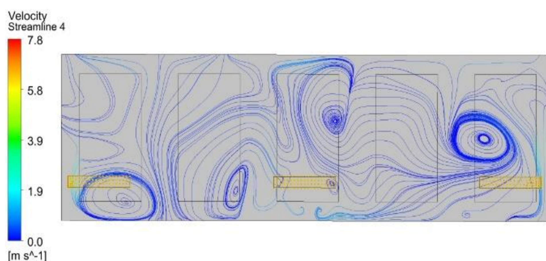
Фиг. 3 Токови линии във вертикален разрез по дължината на помещението
