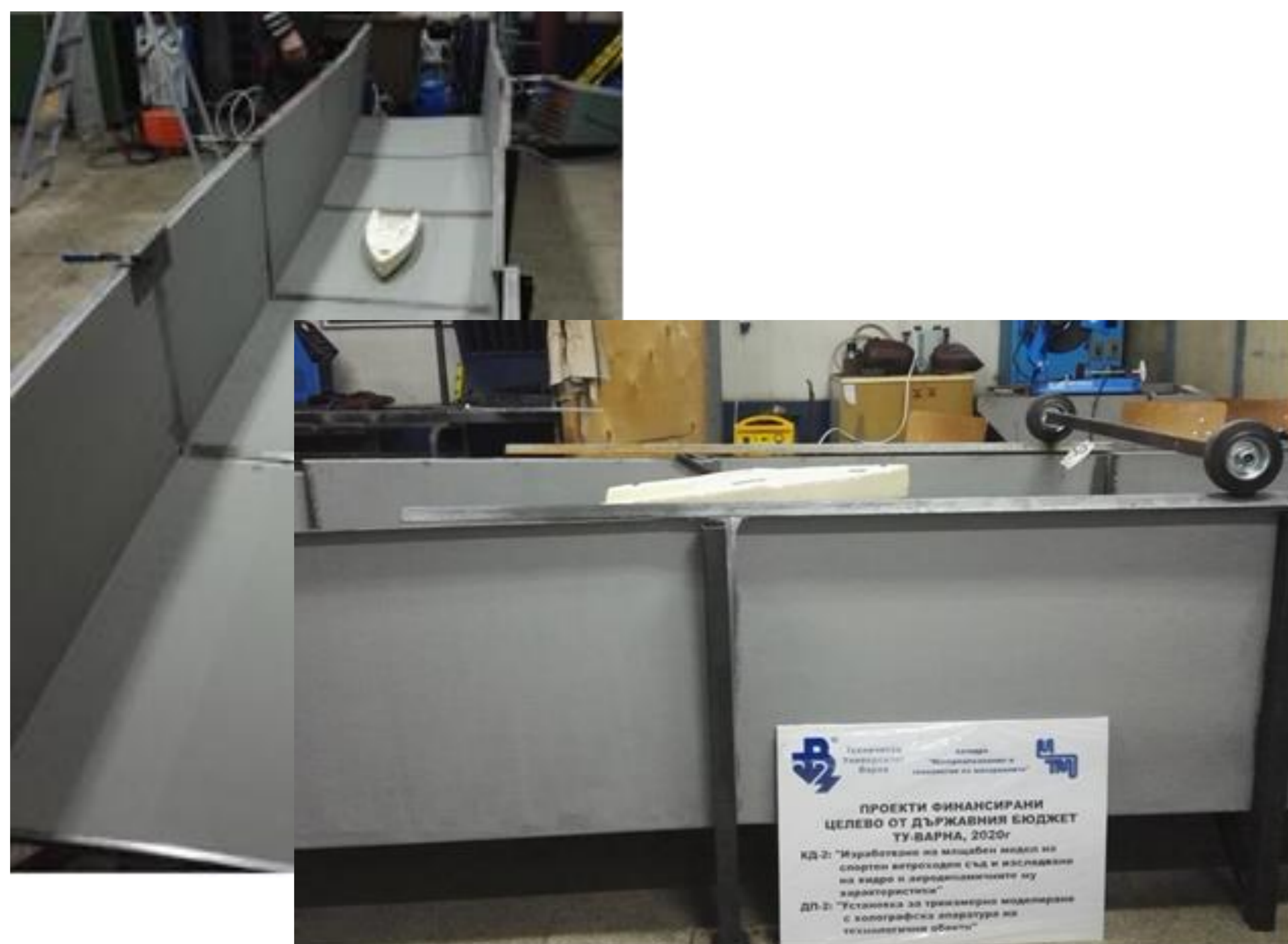
Фиг.2. Изпитвателен 5 метров канал на хидродинамични характеристики на лодка
