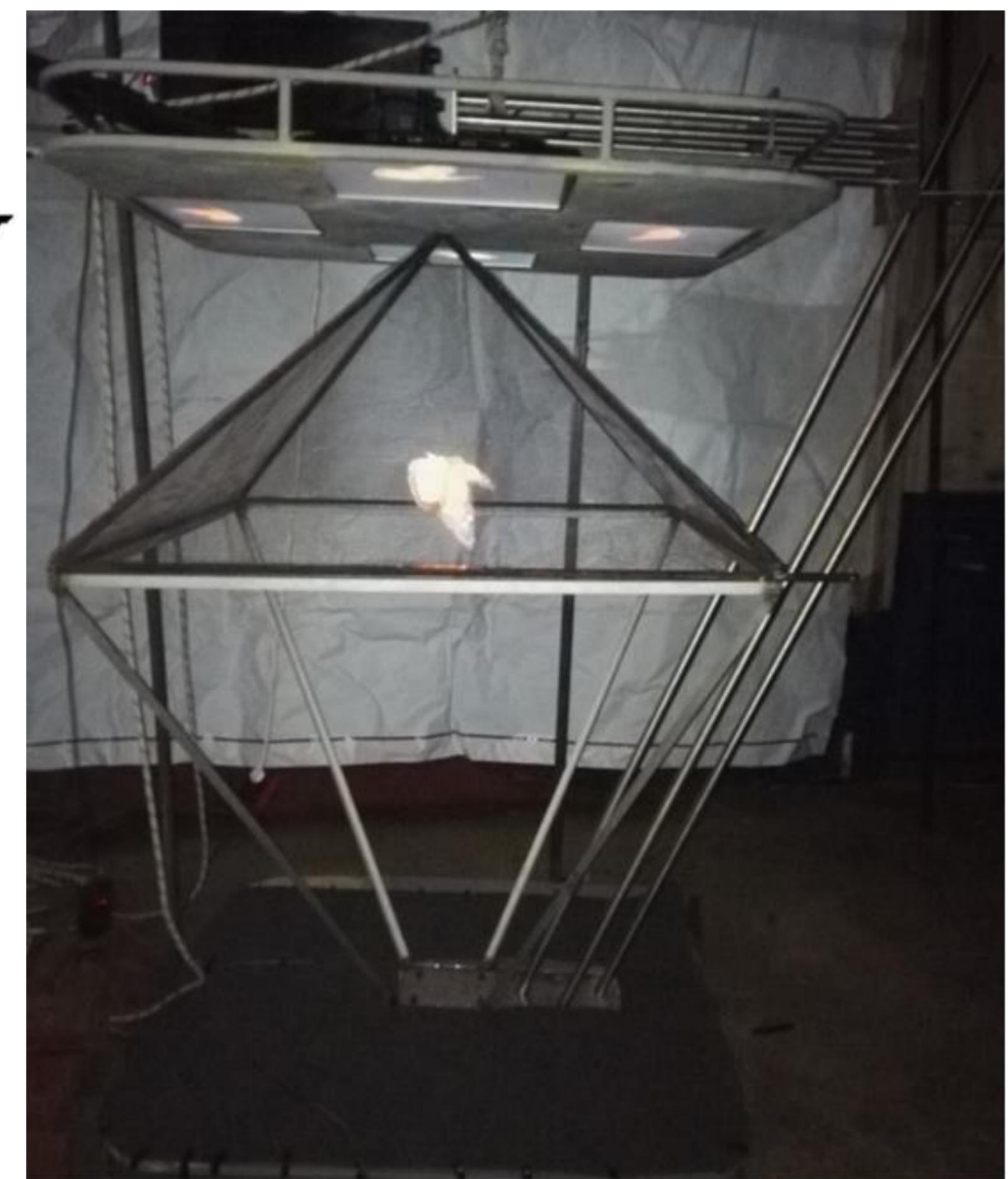
Фиг.2. Общ вид на разработената установка за презентирание на холографски изображения на технологични и архитектурни обекти
