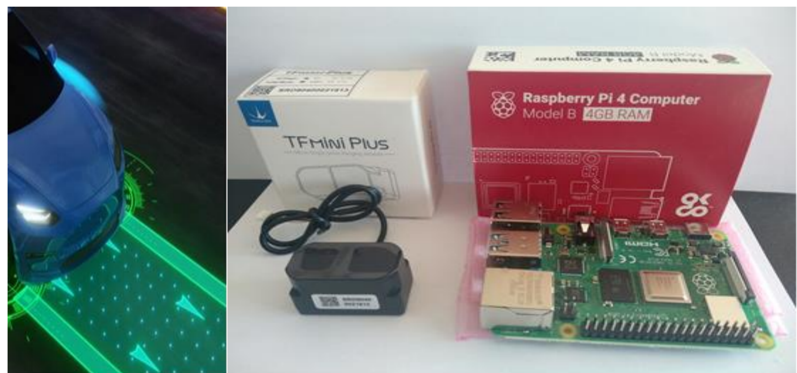
Фиг.3. Датчик лидар и мини компютър
