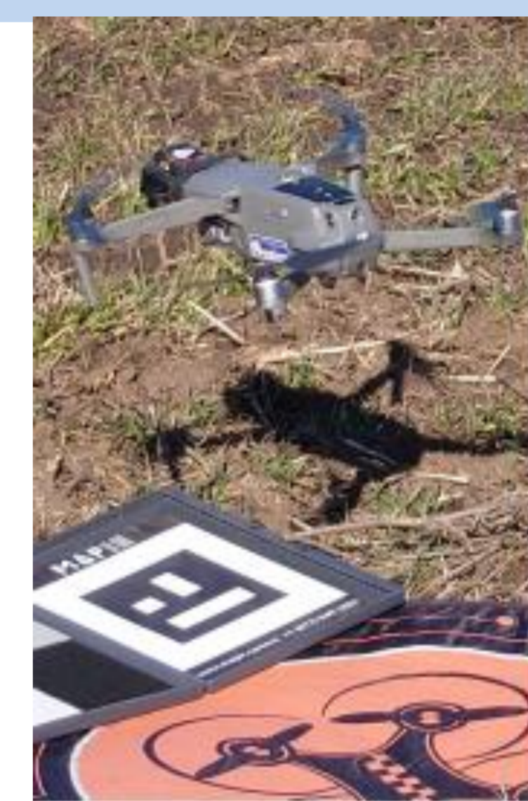
Фиг. 2. DJI Mavic 2 Pro с камера MAPIR
