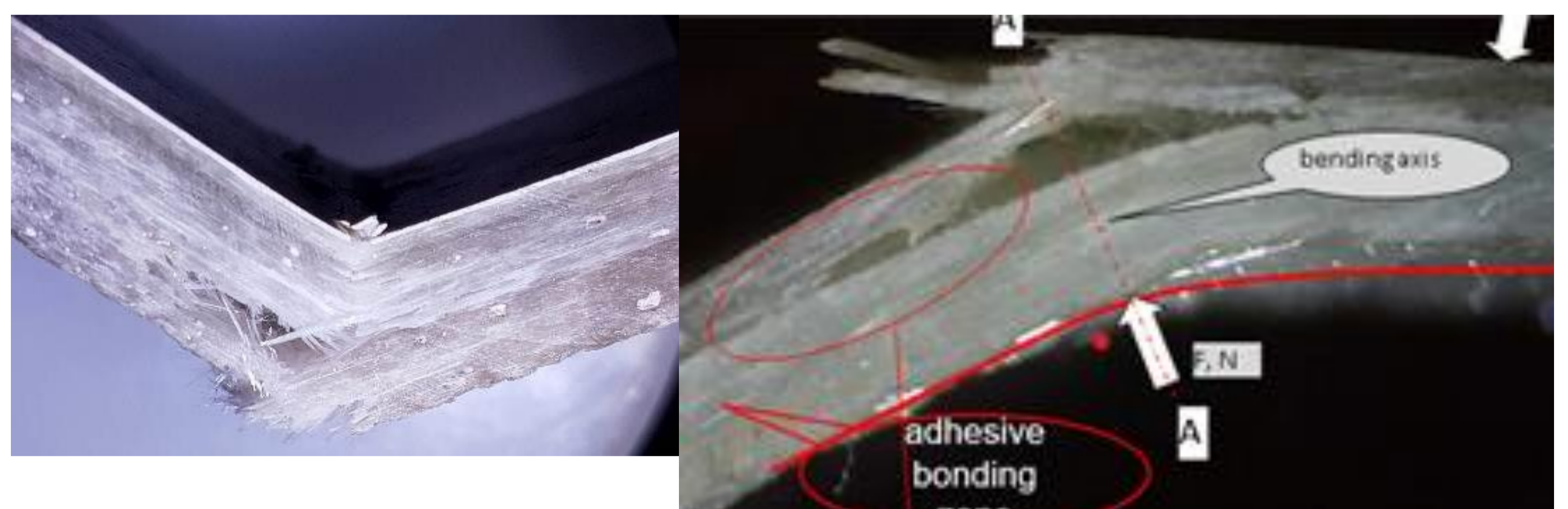
Фиг.2.Макроструктури в мястото на разрушаване на получените образци
