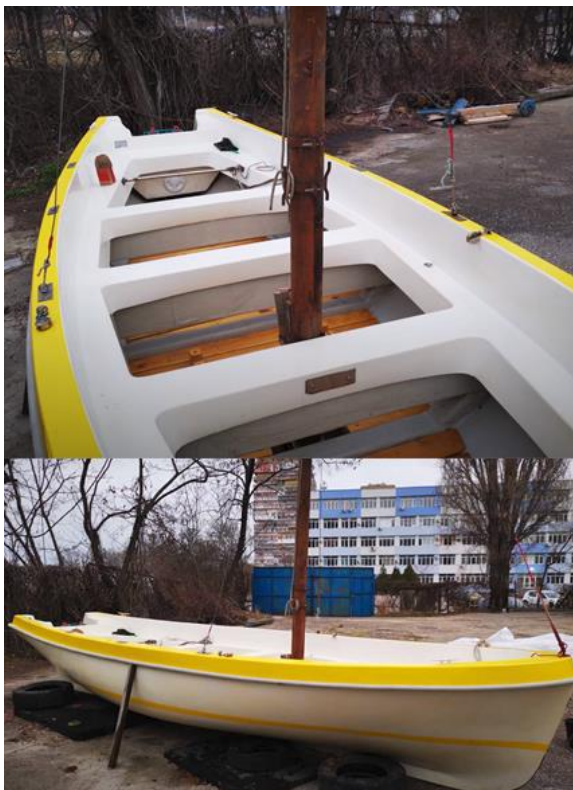
Фиг.1 Ремонт и възстановяване на корпуса на ветроходна лодка ЯЛ-6
