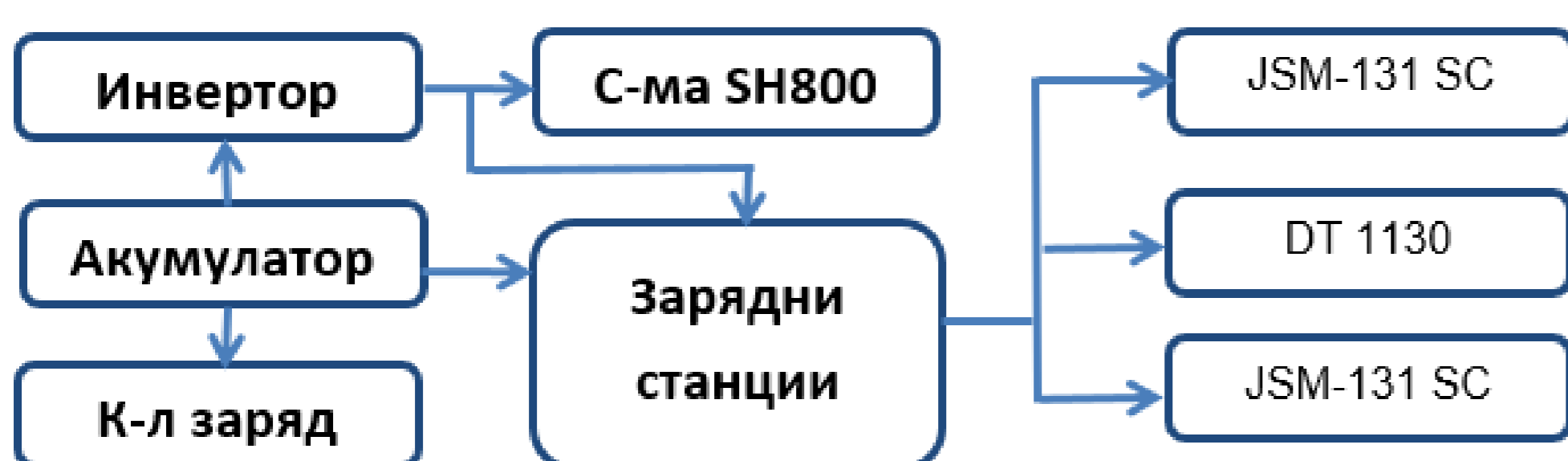
Фиг. 1. Блок схема на измервателната система.
