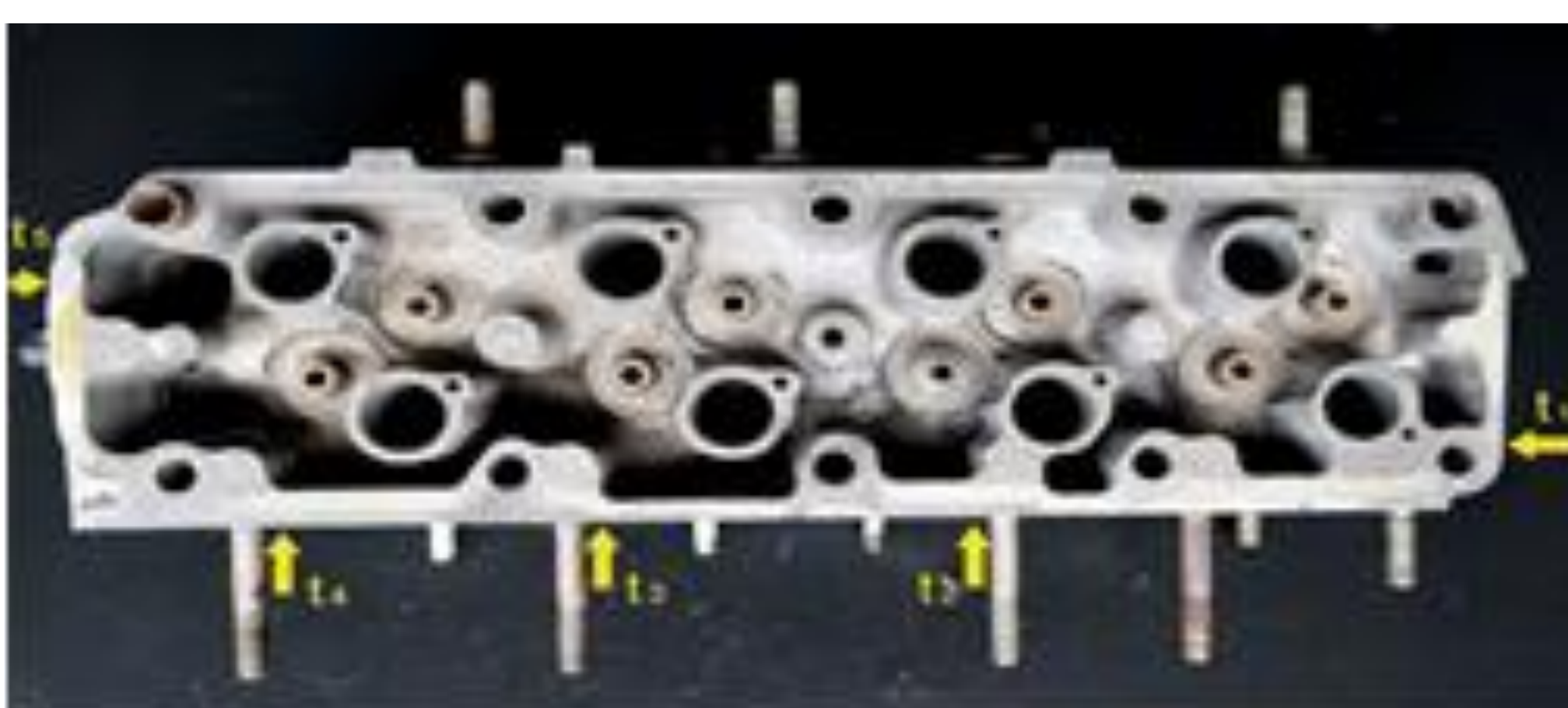
Фиг. 2. Точки по които се измерва температурата чрез инфрачервено термометриране
