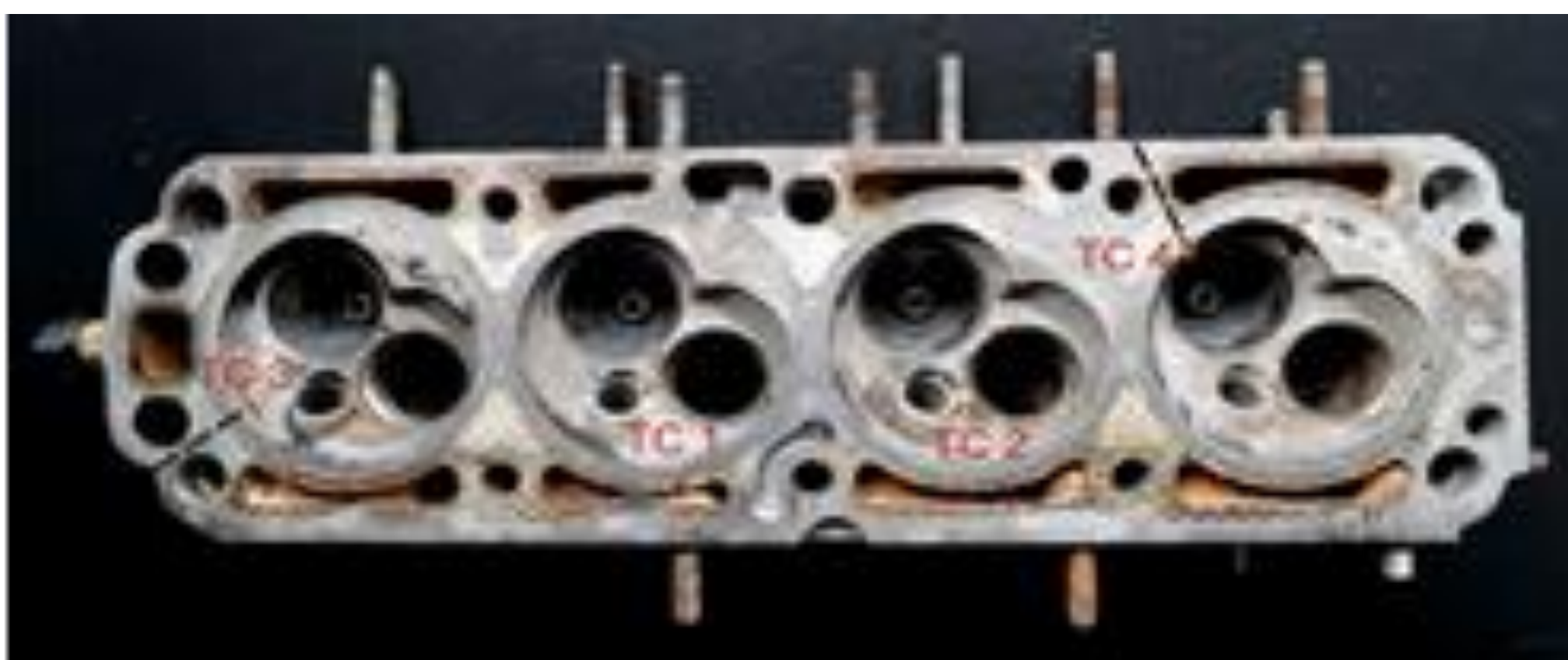
Фиг. 1. Местата на които са монтирани термодвойки, за измерване на температурата на цилиндровата глава.
