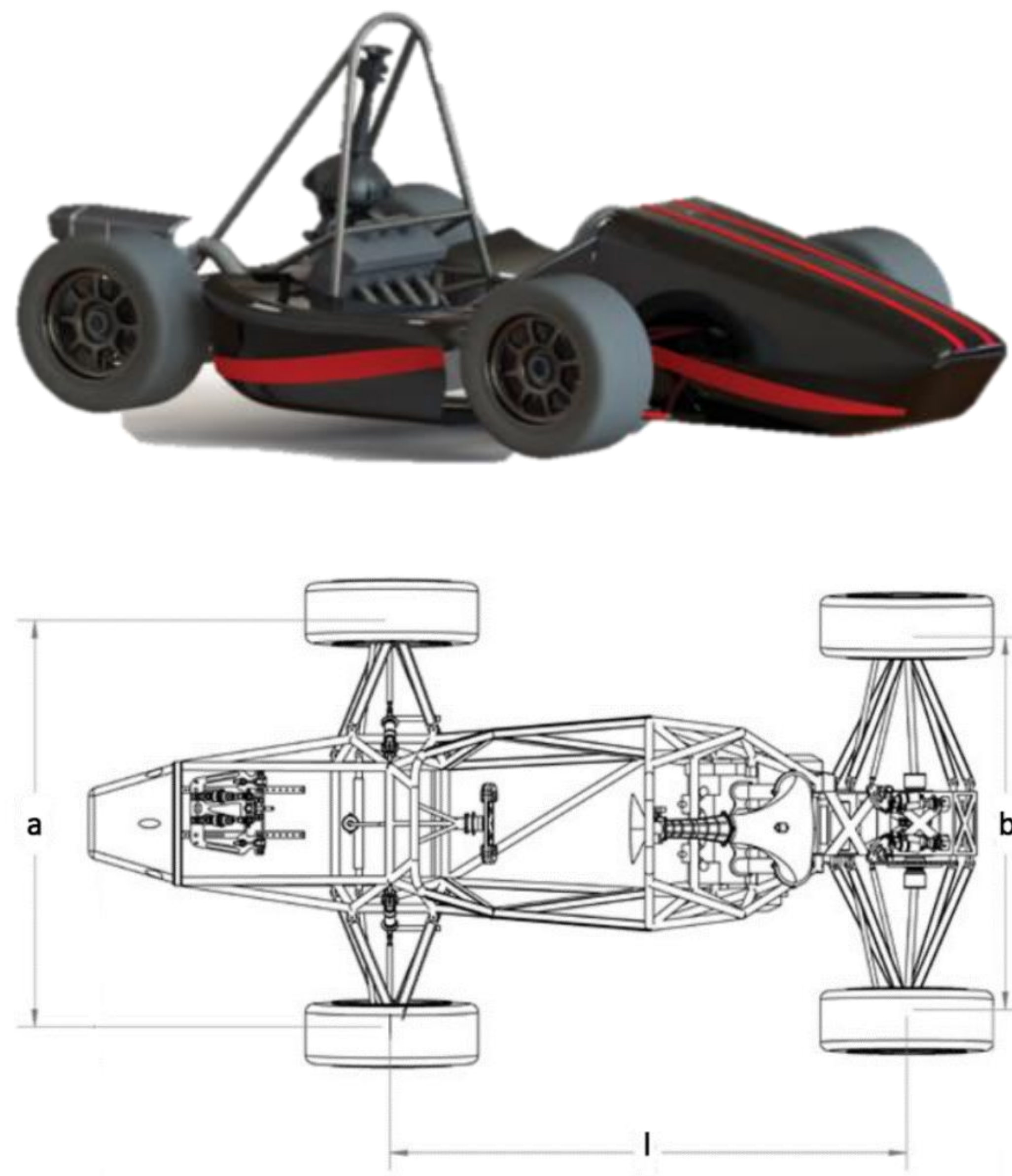
Фиг. 2. Автомобил тип Formula Student където: l – междуосие; a – ширина на предна ос; b – ширина на задна ос
