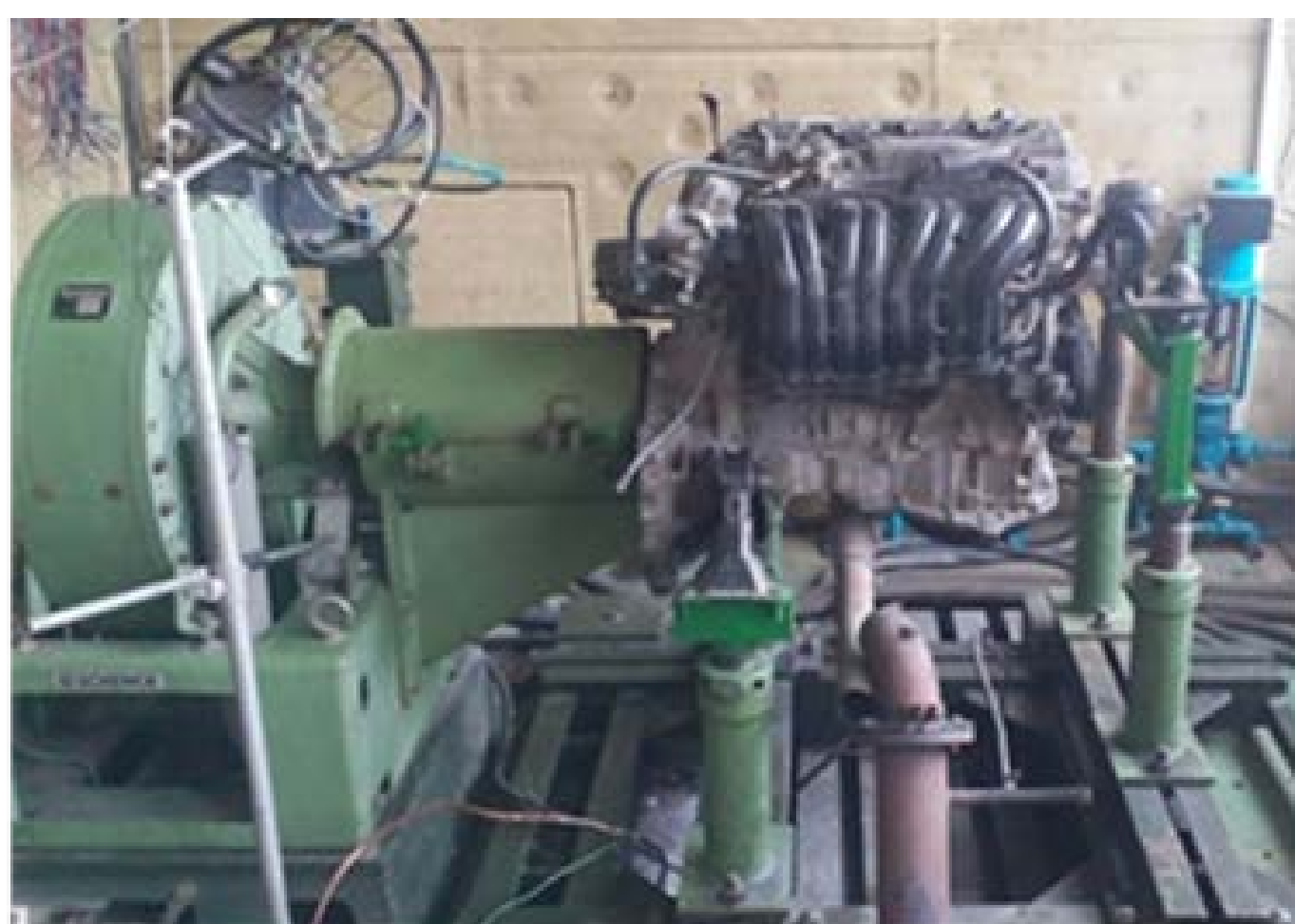
Фиг. 1. Опитна установка двигател 1AZ-FSE и динамометър SCHENCK W230
