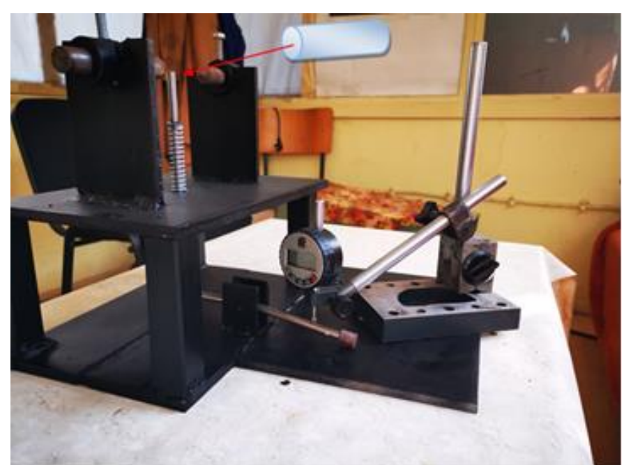
Фиг. 1. Установка за наваряване на пробни тела с възможност за измерване на деформации
