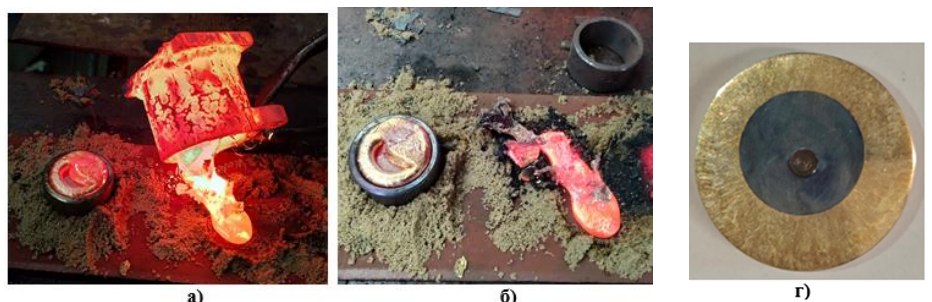
Фиг. 3. Получаване на залята проба, а/заливане на пробата, б/след заливане, в/ струговане, г/проба за структурен анализ и механични характеристики
