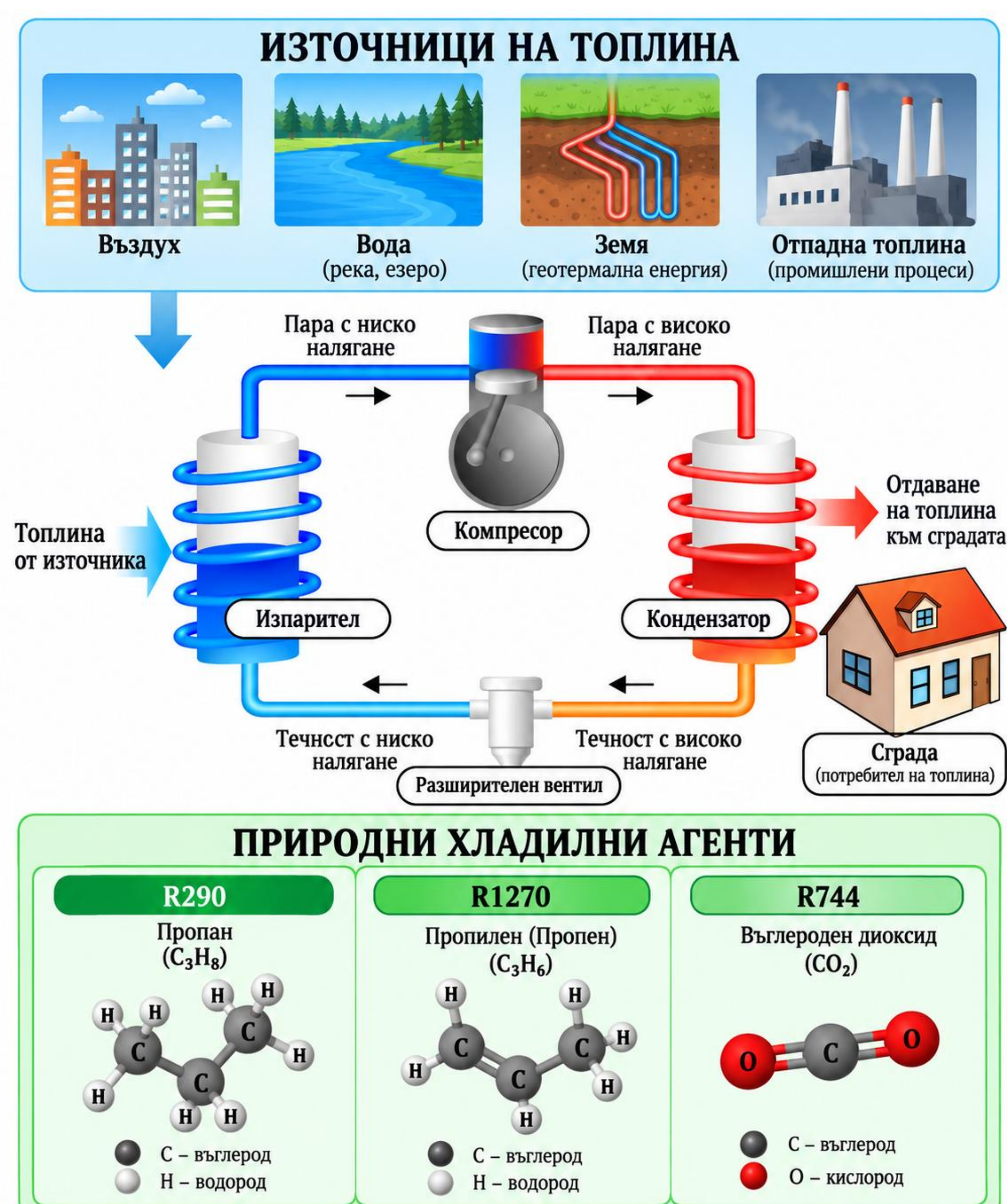
Фиг.1 Схема на термодинамичен цикъл на термопомпа, използваща естествени хладилни агенти и различни топлинни източници.
