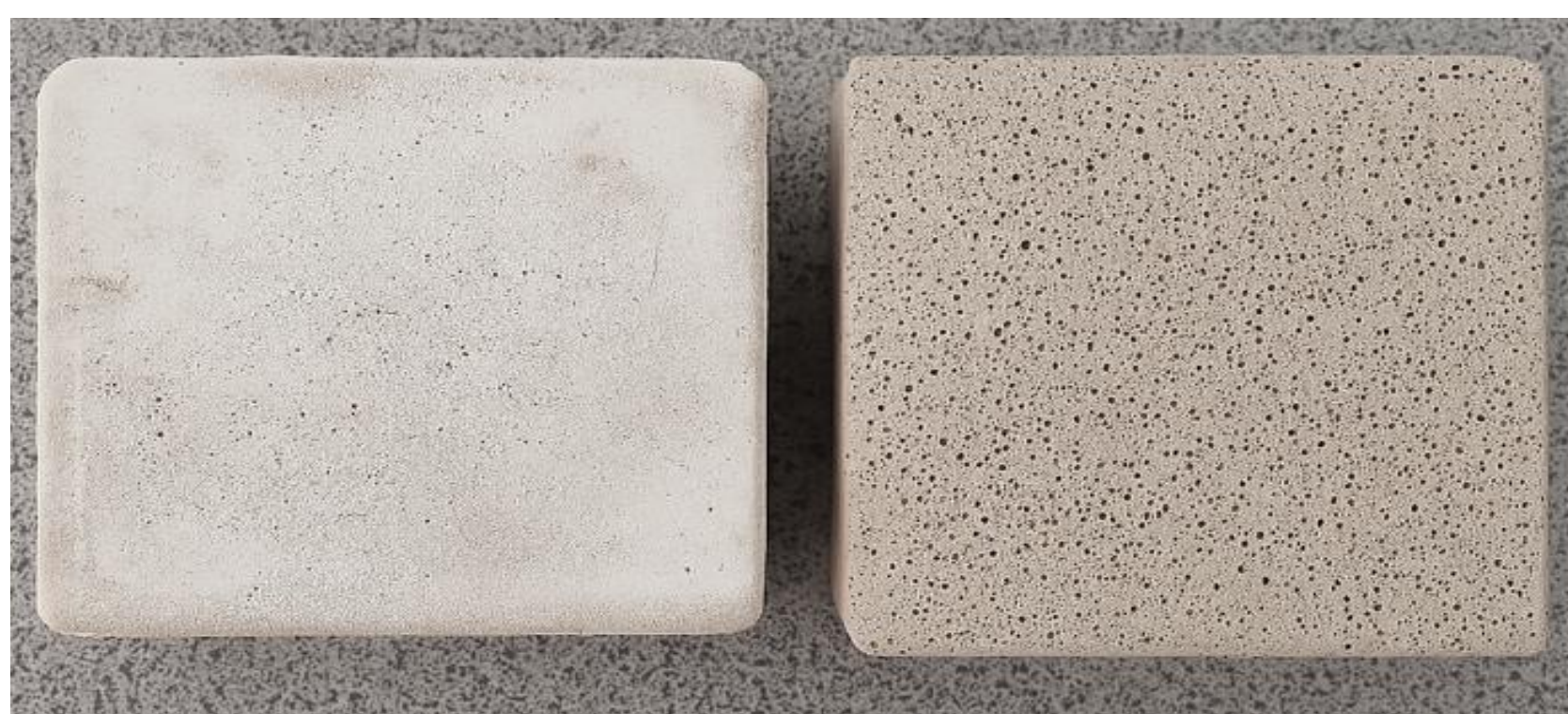
Фиг. 1. Общ вид на изследваните образци: 1 – M1 (клетъчен лек бетон); 2 – M2 (автоклавен газобетон).
