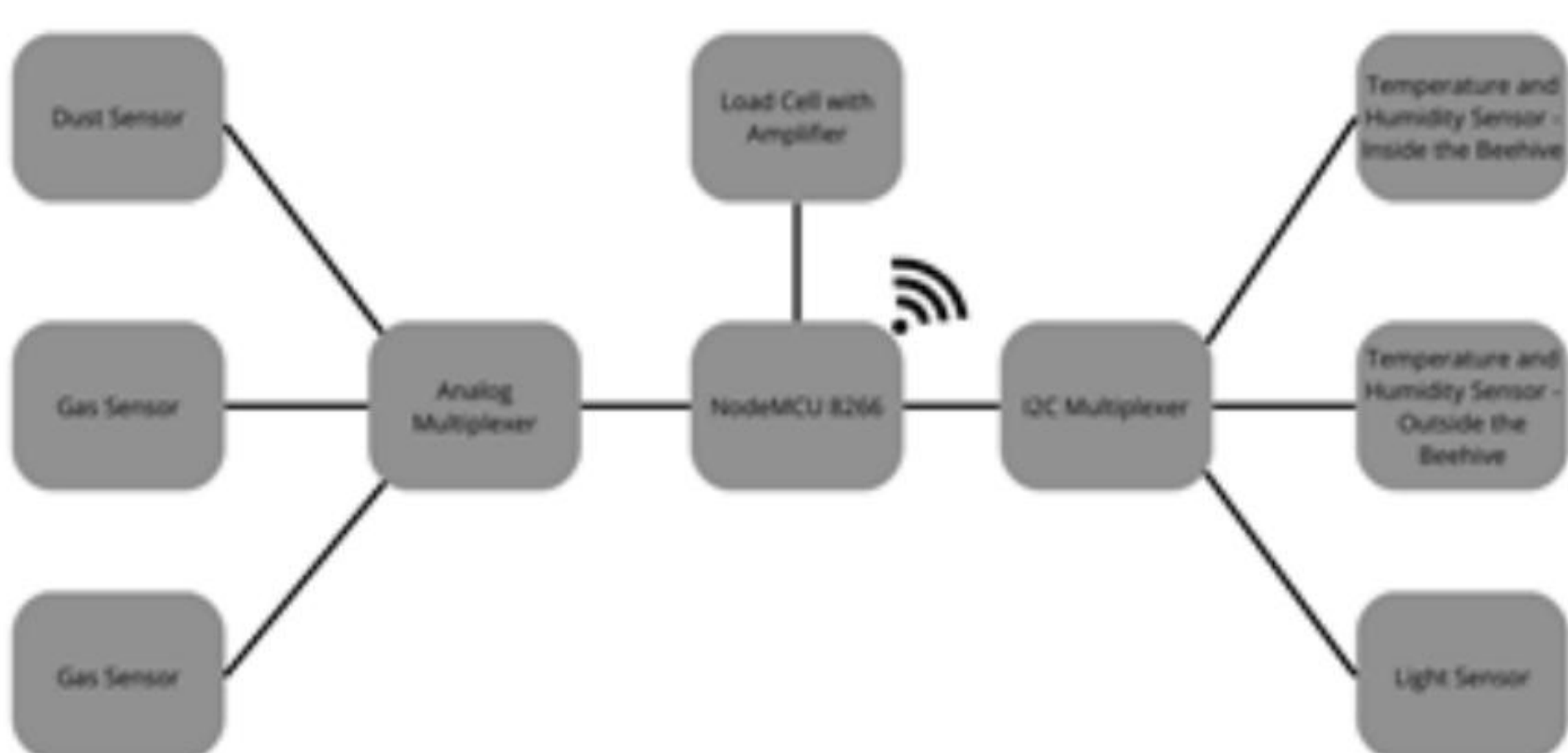
Фиг. 2. Обща схема на апаратно оборудване на система за мониторинг на пчелни семейства
