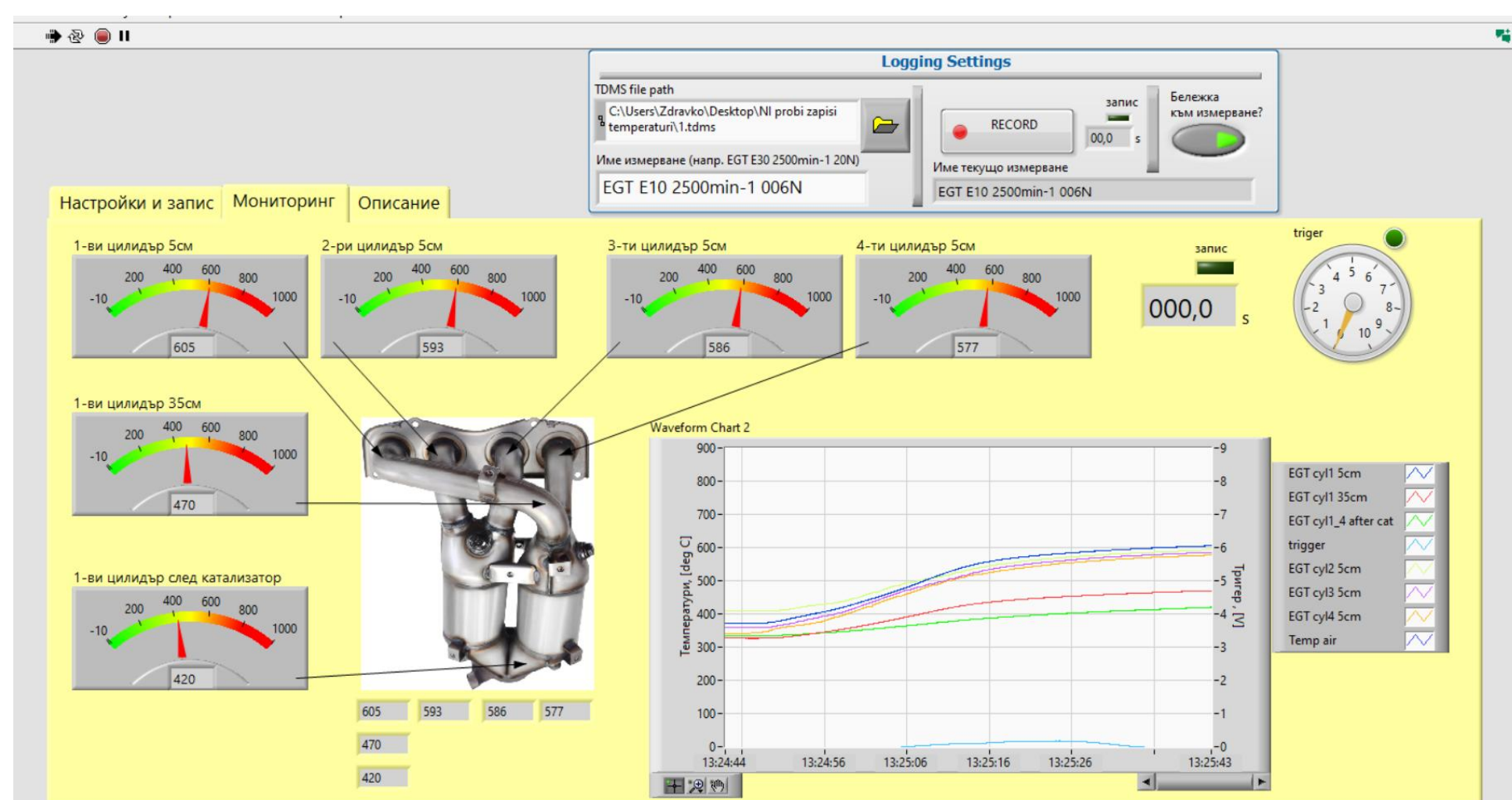
Фиг. 1. Потребителски интерфейс на разработената система за изследване температурата на отработилите газове на ДВГ
